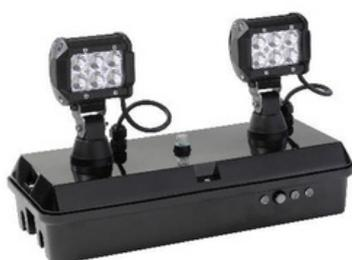
Dans les locaux à grande hauteur, il sera prévu la mise en place de bloc PHARE autonome de TYPE ADRESSABLE de forte puissance lumineuse (2400 Lm). Il sera également étanche (IP65) et devra avoir les phares orientables pour une meilleure répartition de l'éclairage et de façon à s'adapter aussi bien dans les locaux nobles qu'industriels.
