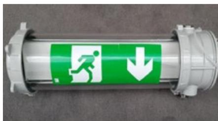
Dans les zones à atmosphère explosive ATEX, les blocs autonomes seront de type SATI Cylindriques en pose plafond ou applique murale conformément au plan d'intégration avec un flux lumineux assigné de 360 lumens pendant 1H, de marque BEHAR Sécurité, série CYLINDRIK type ADF 360 - (réf : 75033) en longueur 480mm ou équivalent.
