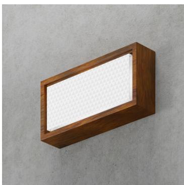
Les blocs autonomes seront de type BI-FONCTION avec un pictogramme sérigraphié simple face rétro-éclairée montés sur un boîtier en chêne massif français ( finition clair, moyen ou foncé) en pose plafonnier, applique murale ou drapeau mural conformément au plan d'intégration avec un flux lumineux assigné de 45 lumens pendant 1H et 8 lumens pendant 5H, en mode non permanent, de marque BEHAR Sécurité, série K-NOPE.
