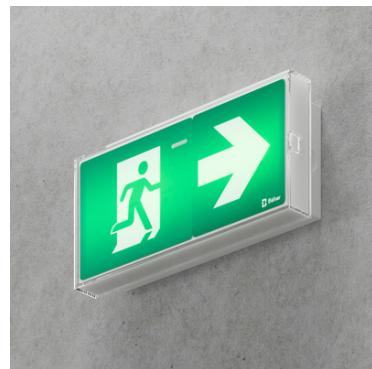
Les zones de parking seront équipées de blocs étanches IP65 de marque BEHAR Sécurité Série ECLAT2 type AET60LO2 (Réf : 37910) en implantation haute. Des blocs munis d'une grille de protection renforcée contre les chocs (IK10) seront implantés en parties basses de type AET609LO2 (Réf : 37918).
