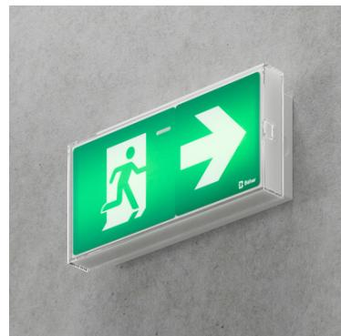
Les zones de parking seront équipées de blocs étanches IP65 de marque BEHAR Sécurité Série ECLAT2 type AET60LA2 (Réf : 34601) en implantation haute. Des blocs munis d'une grille de protection renforcée contre les chocs (IK10) seront implantés en parties basses de type AET609LA2 (Réf : 36205).
